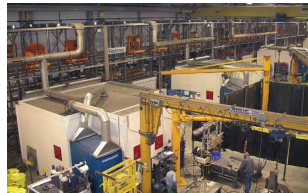
MLS-XMD: 67 m lång, 6,3 m hög, 152 svetspallar, 4 ABB svetsrobotar, 8 häftnings- och inmatnings-/hämtningsstationer; ergonomiskt, enkelt och säkert.
