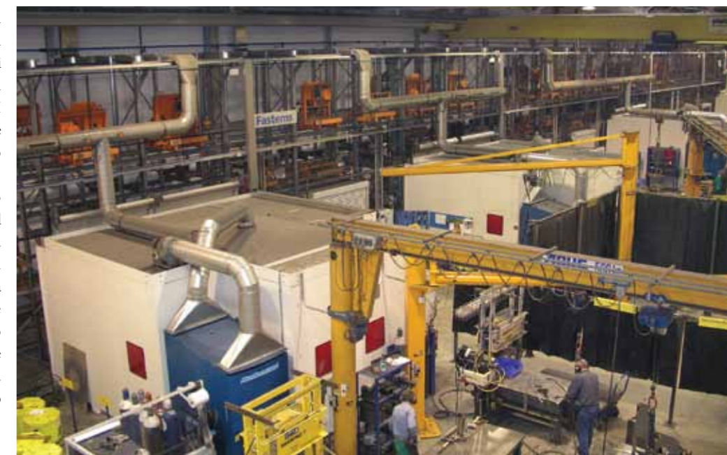
MLS-XMD: lungo 67 metri, alto 6,3 metri, 152 pallet per saldatura, 4 robot per saldatura ABB, 8 stazioni di fissaggio, alimentazione e recupero, ergonomico, semplice e sicuro.
