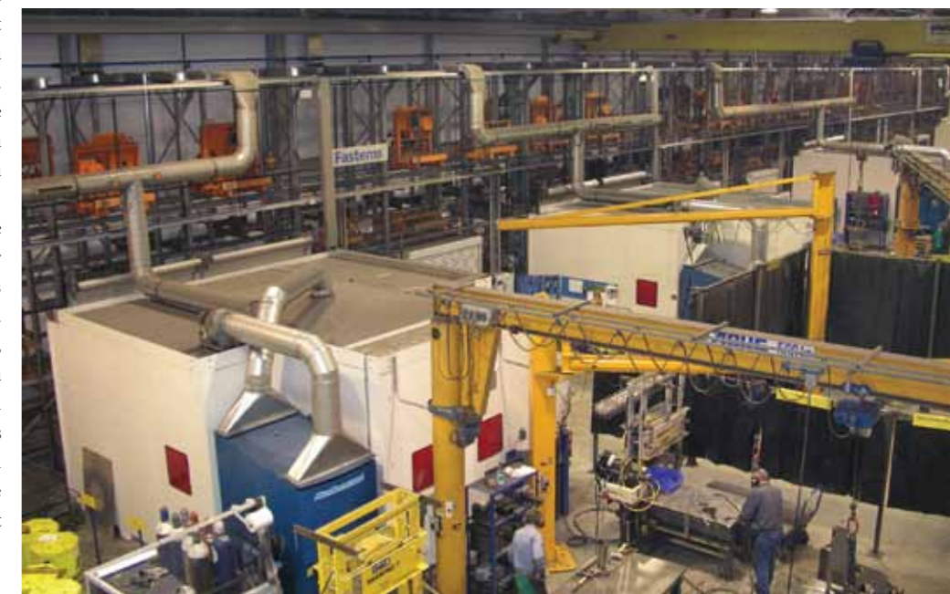
MLS-XMD: 67 m lang, 6,3 m hoch, 152 Schweißpaletten, 4 ABB-Schweißroboter, 8 Heft- und Ein-/ Ausschleußstationen, ergonomisch, einfach und sicher.
