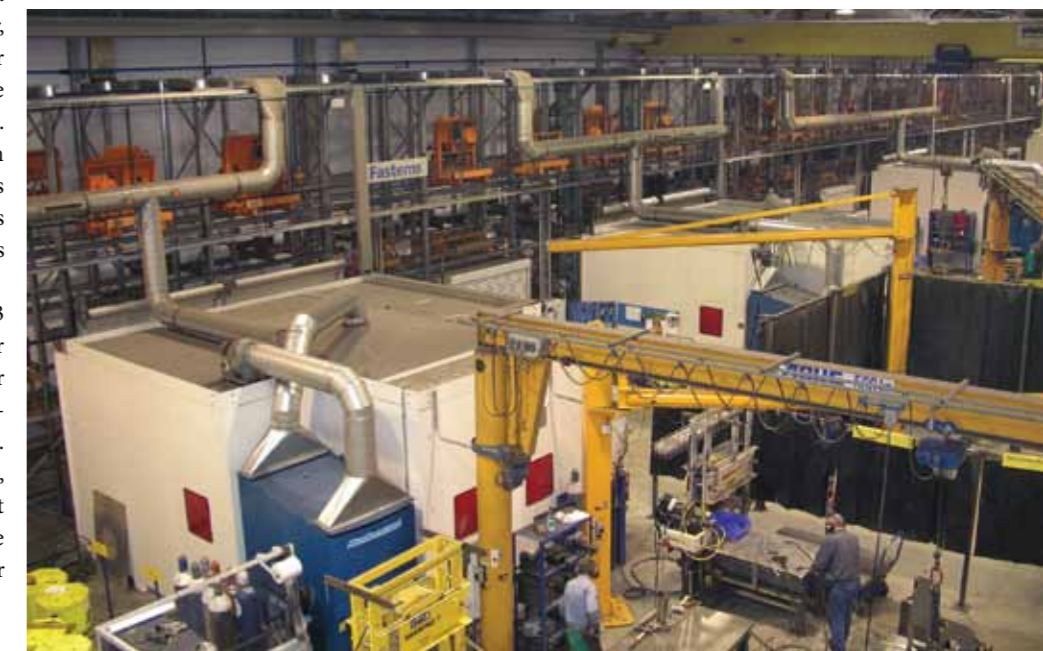
MLS-XMD : 67 m de long, 6,3 m de haut, 152 palettes de soudage, 4 robots de soudage ABB, 8 stations de bridage et d'approvisionnement/de récupération, ergonomique, simple et sécurisé.
