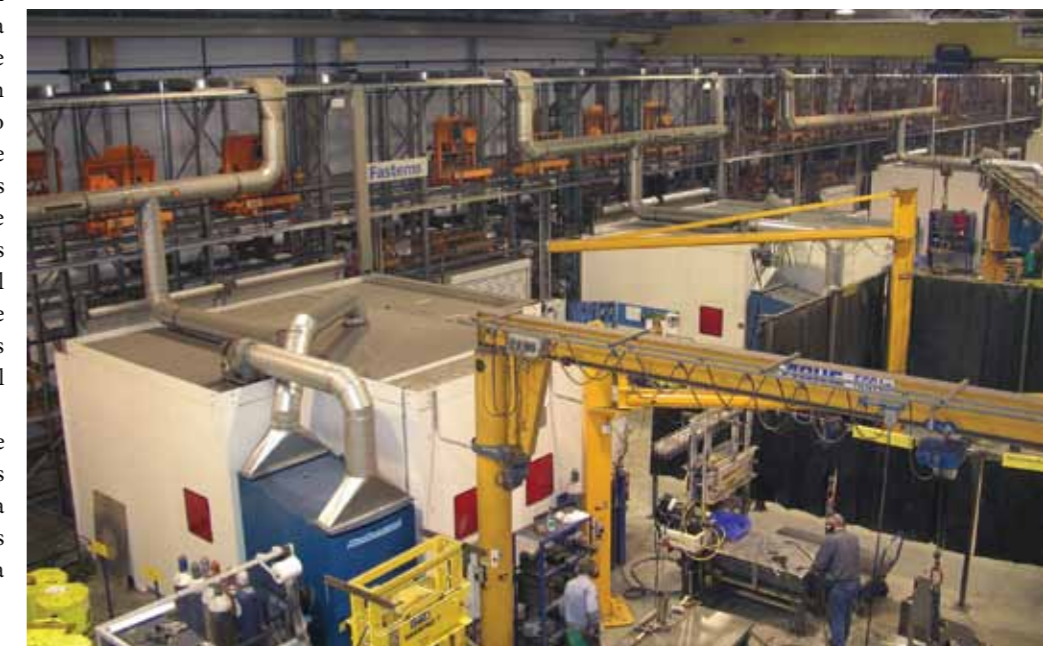
MLS-XMD: 67 m de longitud, 6,3 m de altura, 152 palets de soldadura, 4 robots de soldadura ABB, 8 estaciones de unión y de entrada/recuperación, ergonómico, sencillo y seguro.
