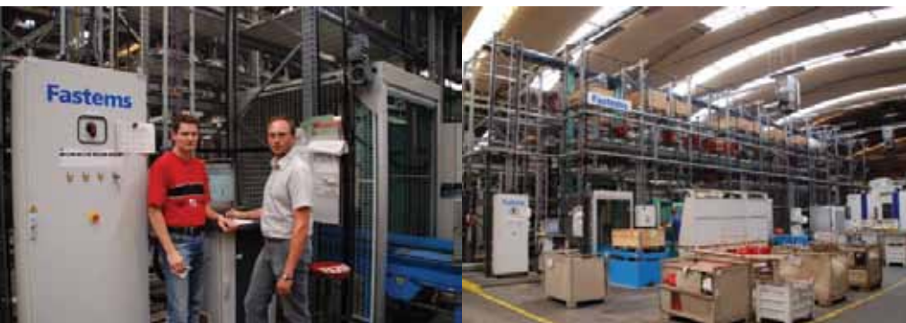
Photo de gauche : M. Franz Eichinger - Directeur de la production technique et de la construction des montages d'usinage (à droite) et M. Oliver Steininger - Directeur de la production mécanique, division I (à gauche). Photo de droite : actuellement le système Fastems dispose de plus de 117 emplacements de palettes, dont 89 sont utilisés pour les pièces usinées et 28 pour les matières premières
