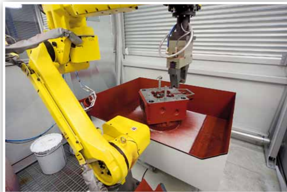
Fanuc-robotti sylinterinkannen maalauksessa.
