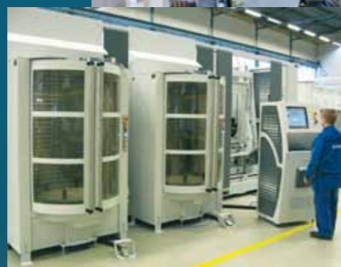
Ergonomisk laddningsstation ger bekväm åtkomst till paletten.
